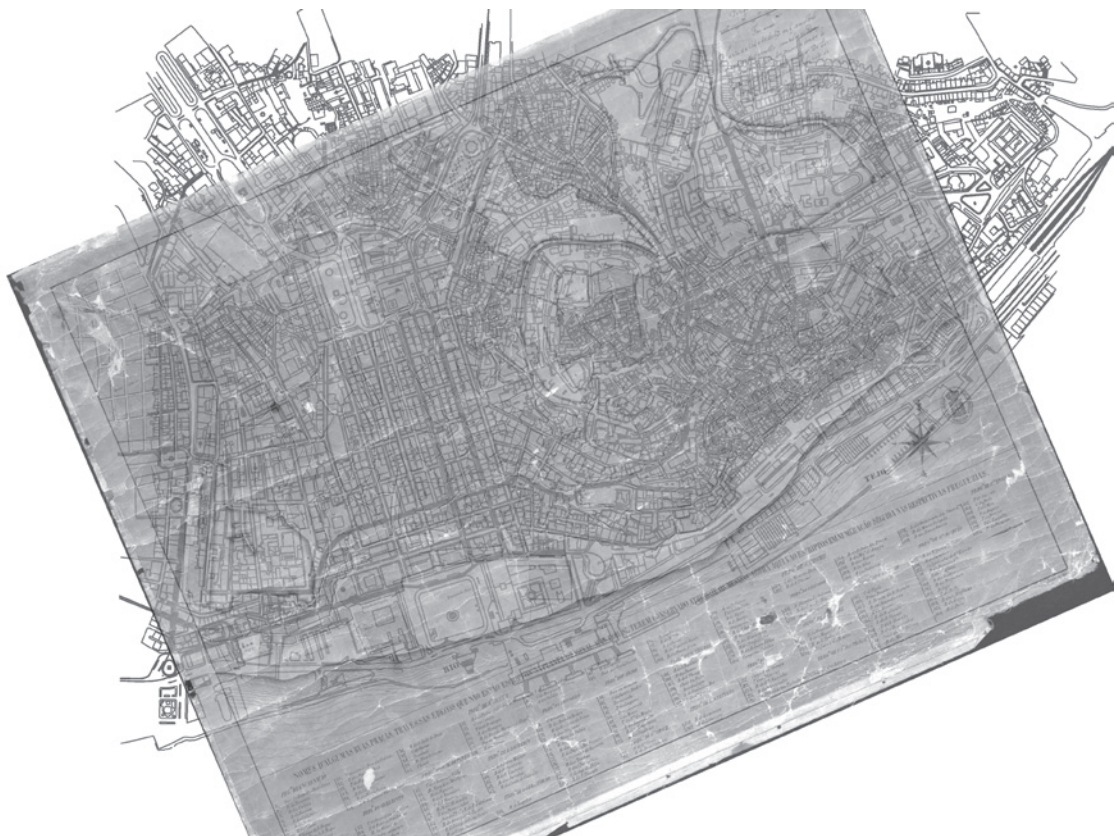
Figura 2 – Exemplo de exercícios de sobreposição entre cartografia digital actual (Câmara Municipal de Lisboa) e a Planta da cidade de Lisboa em q se mostram os muros de vermelho com todas as ruas e praças da cidade dos muros a dentro co as declarações postas em seu lugar de João Nunes Tinoco, em 1650 (projecto SIG elaborado com a colaboração de Ana Vale).
